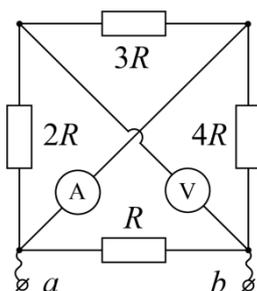
**Задача 5. Электрический квадрат.** Из четырёх резисторов с сопротивлениями  $R$ ,  $2R$ ,  $3R$  и  $4R$  ( $R = 15$  Ом) спаян квадрат, в одну диагональ которого включён идеальный амперметр, а в другую – идеальный вольтметр (см. рис.). Найдите эквивалентное сопротивление  $R_0$  цепи между узлами  $a$  и  $b$ . Какими будут показания амперметра и вольтметра если к узлам  $a$  и  $b$  подключить источник с напряжением  $U = 12$  В?
